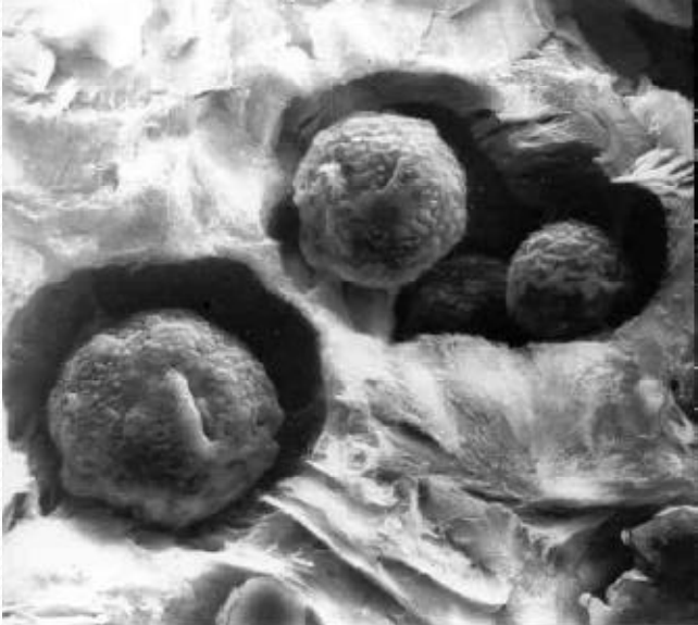
Şekil 2. Küresel grafitli dökme demir, (SEM) görüntüsü (SG Iron SEM View)
