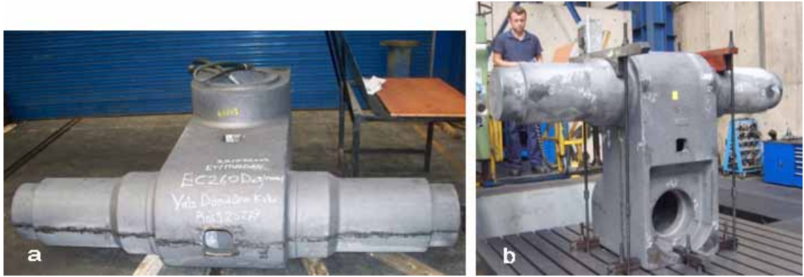
Şekil 11. a.Döküm parçanın temizlenmiş ve b. işleme için tezgâha bağlanmış hali.
