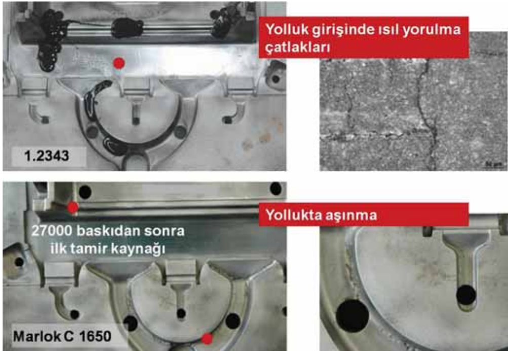
Resim 4: 40.000 baskıdan sonra kalıp incelemesi
